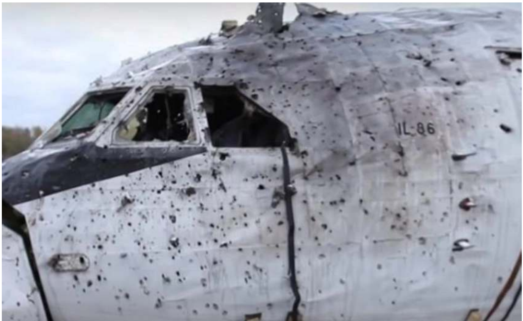
Almaz-Antei-testin lopputulos: Ohjaamo näyttää lieviä kolhuja. Keskiöistä ohjaamon ikkuna särkyi. Yhtenäinen rusetti- ja neliöosumien kuvio. Ei 30 mm reikiä.
