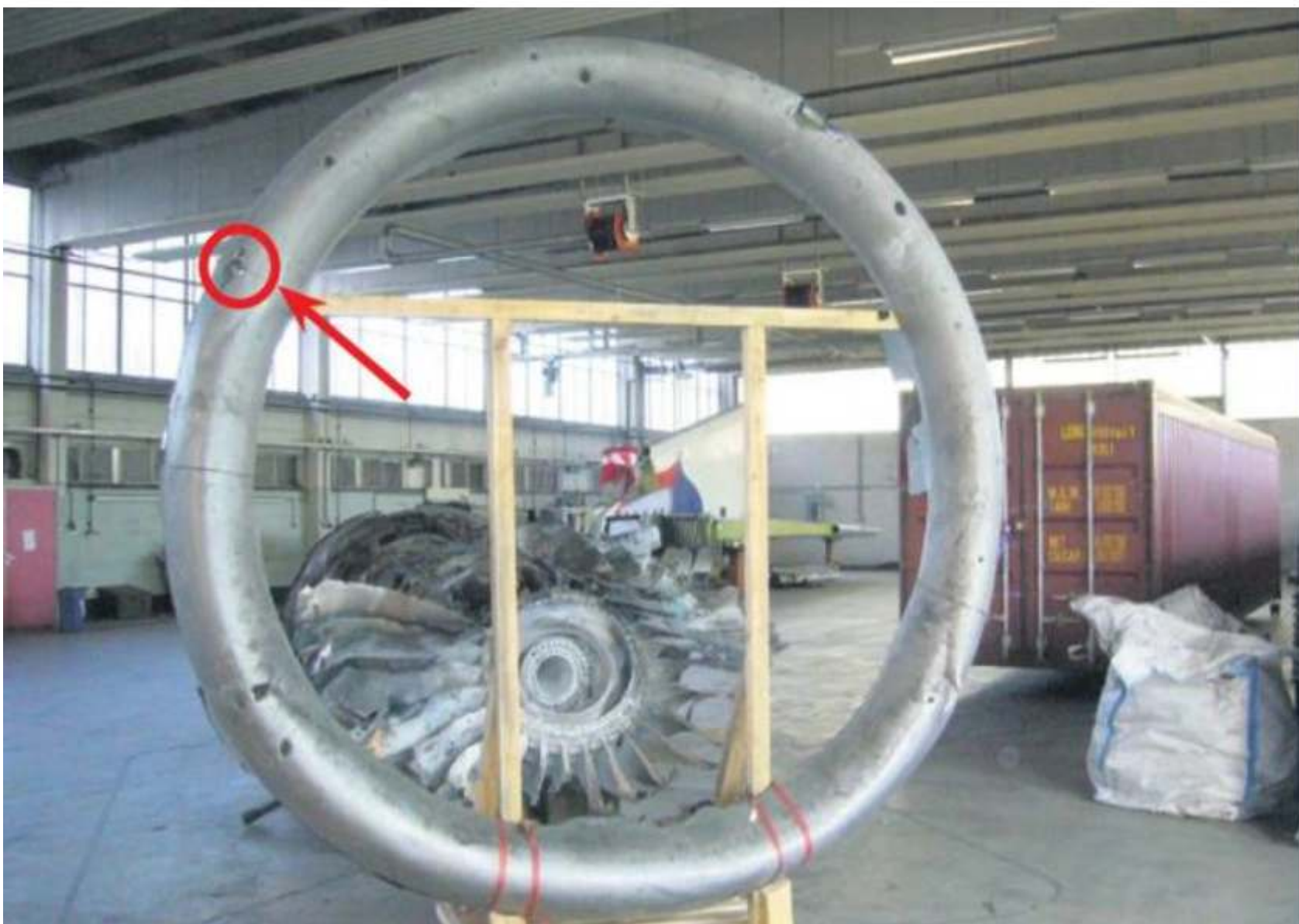
Vasemman moottorin imurenkaan vaurioanalyysi
