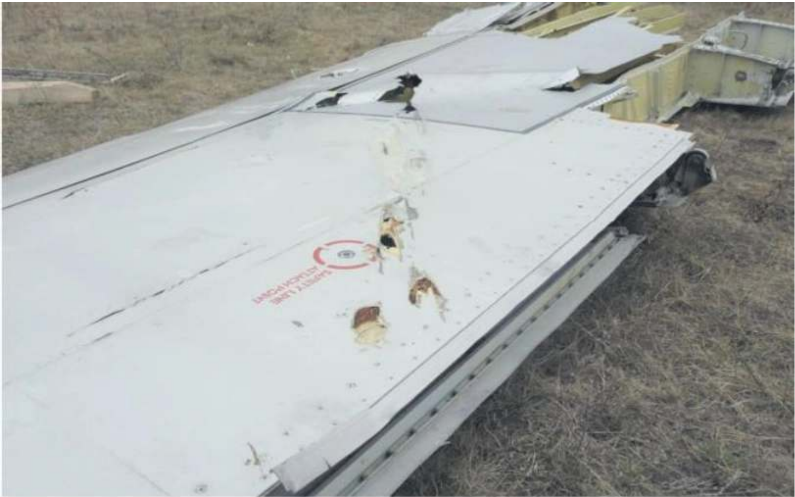
Siiven vaurioiden mallien oikeuslääketieteellinen analyysi
